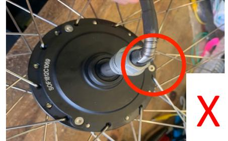
Cas de mauvais emballage et détérioration du câble pendant le transport, moteur non réparable non pris sous garantie
